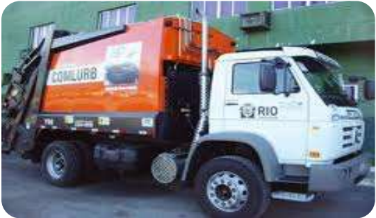
Compactador PBT = 18 t 9 m3
