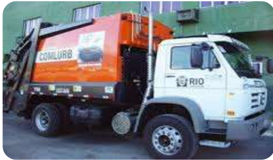
Compactador – P6 - 7 veículos PBT = 18 t 9 m 3
