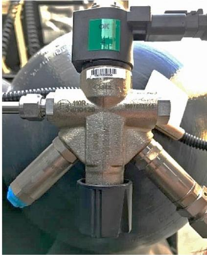
Cada cilindro de gás GNC possui três válvulas de segurança. Protegendo contra o excesso de **temperatura, pressão e rompimentos.**
