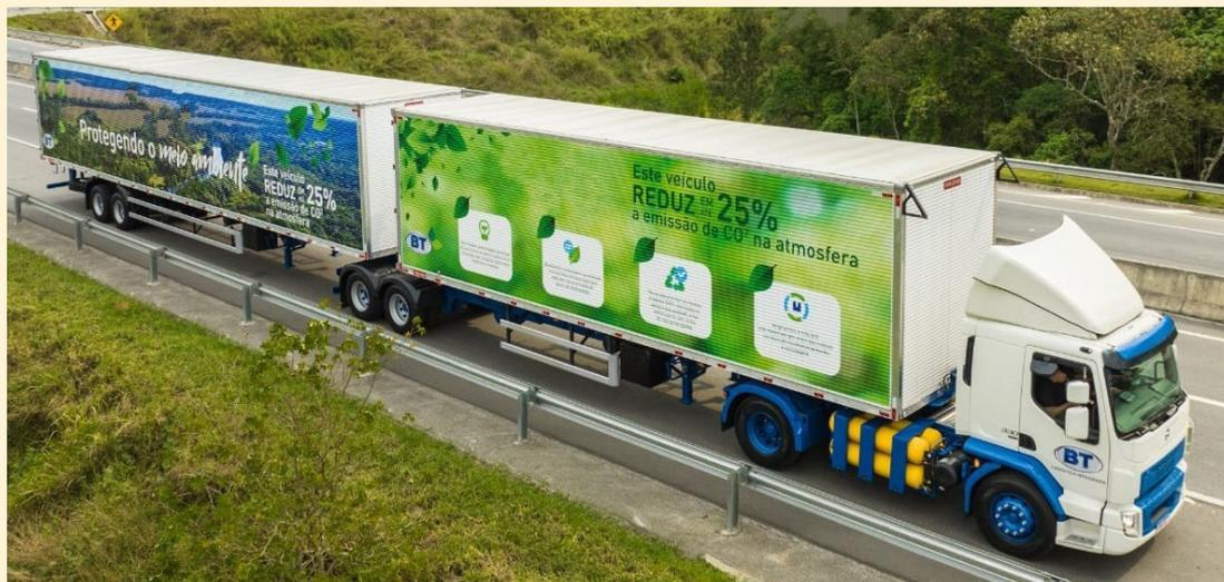
**Fonte de Energia Utilizada por Tipo de Tecnologia (Tabela 2):** A operação é executada utilizando motores de combustão interna do ciclo Otto (ignição por centelhamento), onde a fonte de energia é o GNV, classificado como combustível fóssil. A decisão por GNV ao invés do diesel convencional responde a uma estratégia
