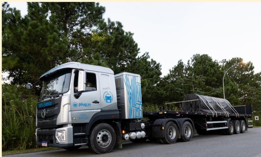
Foram realizados testes com três tipos de veículos (LS, bitrem e rodotrem) em rotas de 20 km e 179 km, que obtiveram a boa aderência desses equipamentos ao perfil da nossa operação e à frota dos transportadores. Os resultados indicaram que esse é o tipo de veículo mais adequado, considerando as tecnologias atualmente disponíveis no mercado, para enfrentar o desafio da descarbonização do transporte rodoviário em nossas operações de escoamento de produtos.
